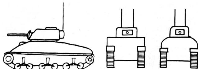
Die moderne Entwicklung der Panzer, die vor allem die Stärke der Panzerung und die Vermehrung der Bestückung betrifft, führte zu immer schwereren Kampfwagen, die gleichzeitig auch eine Vergrößerung der Außenmaße zur Folge hatte. Heute kann mit einer Länge von 7 Metern, einer Breite von 2,5—3 Metern und einer Höhe von 2—3 Metern gerechnet werden.
