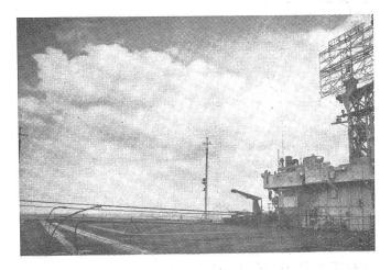
Auch die amerikanischen Flugzeugträger wurden mit der neuen Apparatur ausgerüstet, um gegen Angriffe von Unterseebooten geschützt zu sein. Wir sehen hier die Antenne auf dem Mast (in der Mitte des Bildes) auf dem Flugzeugträger «Croatan».
