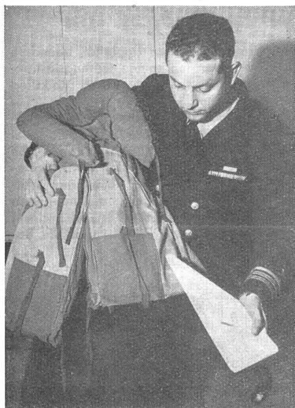
So sehen die Panzerplatten aus gesponnenem Glase aus, die in Westen eingehänt werden. Der neue persönliche Panzer wurde erst nach dem Kriege in Amerika entwickelt und schützt sicher vor kleinen Kalibern und Granatsplittern. Vorangegangen sind diesen Versuchen Experimente mit den Fliegern bei Okinawa, die Flakschutz-Anzüge aus Nylon, dem neuen Faserstoff, trugen.
