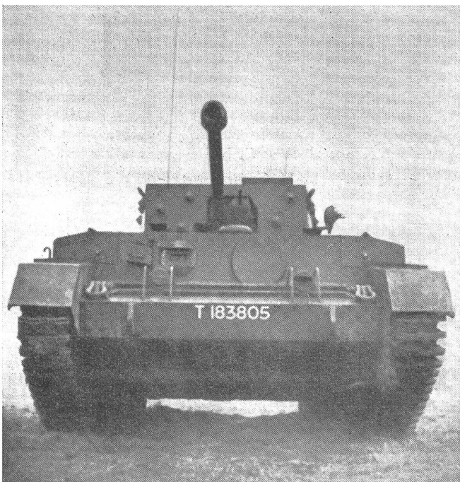
Der «Centaur»-Panzerkampfwagen, ein Vorläufer des «Cromwell»-Tanks. Bewaffnung besteht aus einem Sechspfünder-Geschütz
