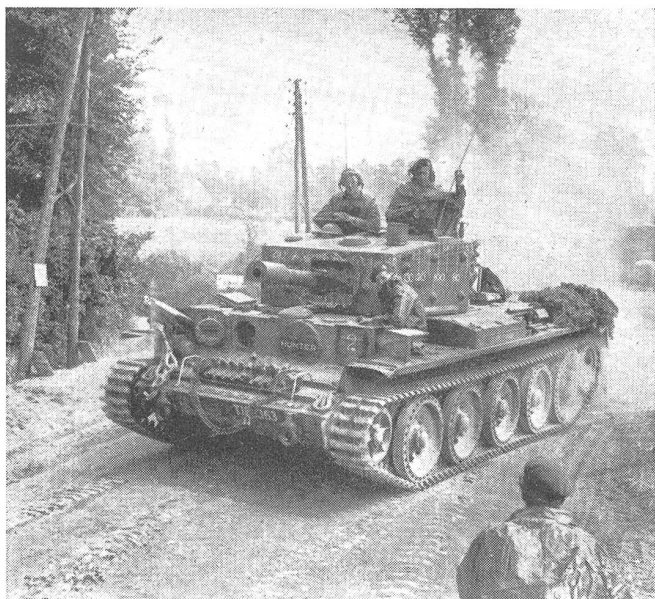
«Cromwell»-Panzerkampfwagen mit 95-mm-Haubitze ausgerüstet.
