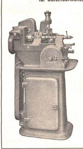
Halbautomatische Abwälzräderfräsmaschine Nr. 1 Type 75
