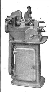
Halbautomatische Abwälzräderfräsmaschine Nr. 1 Type 75
