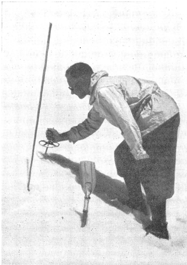
Demonstration der Skistock-Sondierstange, mit welcher, nachdem durch eine einfache Manipulation der Griff des Stockes abgestreift wurde, Sondiertiefen bis 1,2 m im Lawinenschnee ermöglicht werden. Im Vordergrund, im Schnee steckend, die kombinierbare Ski-Ersatzspitze und Schneeschaufel.
