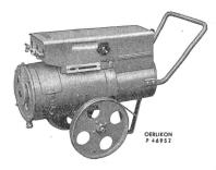
Die neuen 230 A- und 350 A-Schweißgruppen bewähren sich nicht nur bei allen Schweißarbeiten in Eisen und Stahl, sondern gestatten auch die Schweißung von modernen Speziallegierungen und Buntmetallen. — Die Stabilarc-Schweißurguppen eignen sich ferner für Dünnblechschweißung und für schwierigste Arbeiten mit Sonderelektroden.
