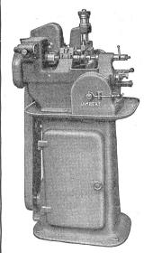
Halbautomatische Abwälzräderfräsmaschine Nr. 1 Type 75
