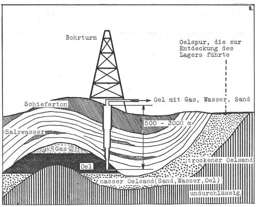
Erdöllager (sog. Faltenlager) in schematischer Darstellung.
