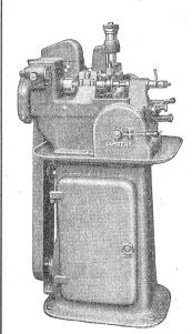
Halbautomatische Abwälzräderfräsmaschine Nr. 1 Type 75
