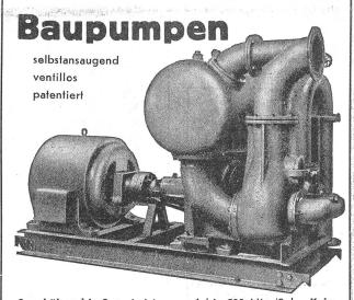
Saughöhen bis 9 m, Leistungen 1 bis 500 Liter/Sek. Kein Bodenventil - Keine Klappe im Saugstutzen - Keine Hilfs-Vakuum-Pumpe - Jederzeitiges autom. Ansaugen auch nach Lufteintritt im Saugrohr. Keine reibenden, sich abnützenden Flächen, daher unempfindlich gegen Sand, Schlamm und Kies.
