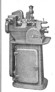
Halbautomatische Abwälzräderfräsmaschine Nr. 1 Type 75
