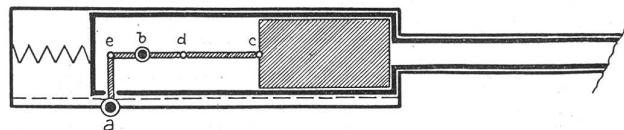
Wären die freien, in dieser Lage gestreckten Gelenke c—d—e auf die hintere Wand des Systems abgestützt, dann würden System und Verschluß einen Block bilden, ohne daß der Verschluß geöffnet würde. Die auf dem «toten Punkt» stehenden Gelenke würden steif in dieser Lage verharren; der Verschluß wäre sozusagen endgültig verriegelt.
