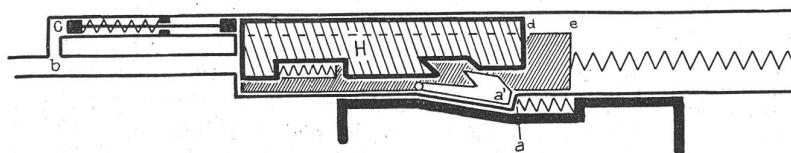
Im vorliegenden Falle dient die Gasentnahme nur dazu, die Waffe zu entriegeln. Die Anbohrung des Laufes braucht deshalb nicht am vordern Ende zu erfolgen. Der Weg des Kolbens c ist klein.
