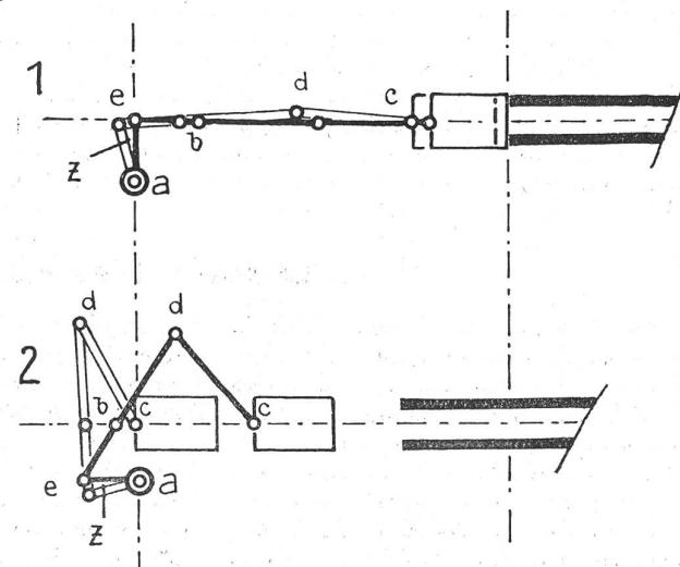
Einer Drehung z des Stützgelenkes um den Punkt a entspricht im ersten Fall ein bedeutend geringeres Brechen der Gelenke e—d—c als im zweiten. Praktisch kann Fall 1 als noch verriegelt betrachtet werden.
