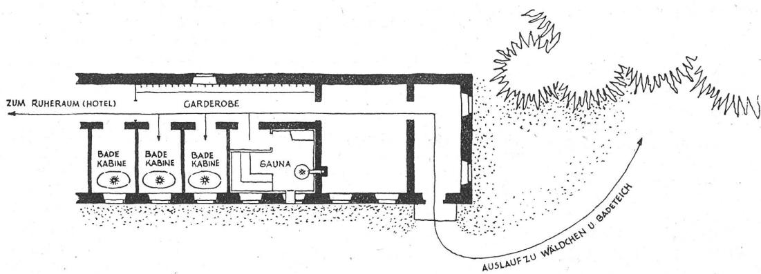
1. Situation: Die Sauna konnte in die Badeanlagen eines Kurhotels eingebaut werden. Zum Waschen und Abkühlen können — je nach Frequenz — Badekabinen benutzt werden. Dadurch Einsparungen an sanitären Installationen. Fassungsvermögen ca. 8 Mann.
