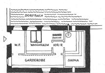
2. Situation: Einbau einer Sauna mit Nebenräumen in eine alte Schmiede. Der Raum konnte frei unterteilt werden. Ruheraum im nahen Kantonnement. Fassungsvermögen ca. 8 Mann.
