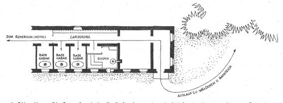
1. Situation: Die Sauna konnte in die Badeanlagen eines Kurhotels eingebaut werden. Zum Waschen und Abkühlen können — je nach Frequenz — Badekabinen benützt werden. Dadurch Einsparungen an sanitären Installationen. Fassungsvermögen ca. 8 Mann.
