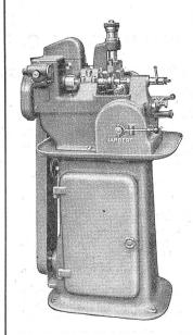
Halbautomatische Abwälzräderfräsmaschine Nr. 1 Type 75
