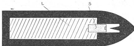
Beim Auftreffen auf hartem Boden plumpst die Sprengkapsel (S) kurz nach dem Abbremsen des Geschosses, infolge des Beharrungsvermögens, auf den Schlagbolzen und bringt die Sprengladung zur Detonation.
