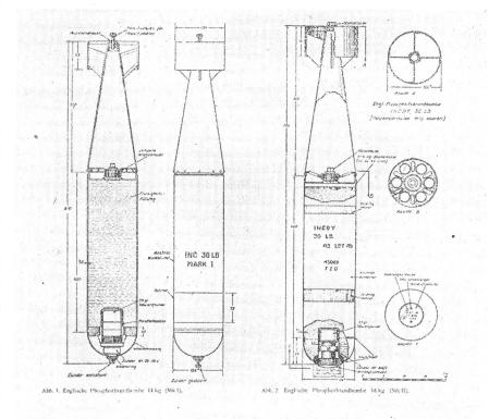
Englische Phosphorbrandbombe mit flüssigem Rohkautschuk. Typ: JNC. 30 LB Mk. I und Mk. II, Gewicht 14 kg, Gesamtlänge 81 cm. Zusammensetzung der Zündflüssigkeit: Benzin 87 %, flüssiger Kautschuk 10 %, Phosphor und Schwefel 3 %.
