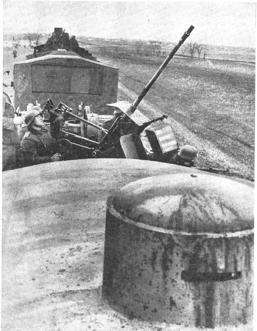
Flakgeschütze sichern den Zug gegen Luftangriffe. (Im Vordergrund die Gefechtsstand-Panzerkuppel des Zugskommandanten.)
