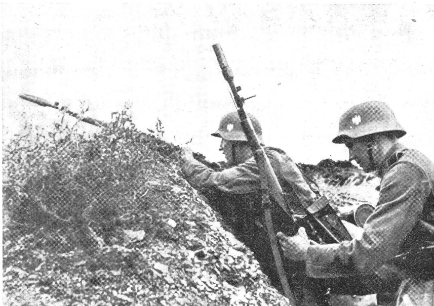
Ein wieder erstandenes Mittel des Stellungskrieges: die Gewehrgranate. Mittels eines Trichters vor die Laufmündung des Gewehres aufgesetzt, wird die Gewehrgranate durch Abfeuern einer gewöhnlichen Gewehrpatrone abgeschossen.
