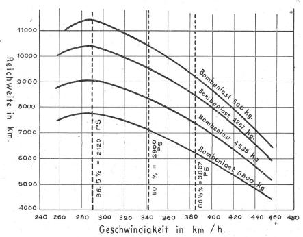
Die Leistungsgrenzen des «Heinkel He 177», der imstande sein soll, den Atlantischen Ozean ohne Zwischenlandung zweimal zu überqueren. Die ausgezogenen Kurven geben an, welche Strecke das Flugzeug bei einer bestimmten Geschwindigkeit mit der angegebenen Bombenlast zurück-
