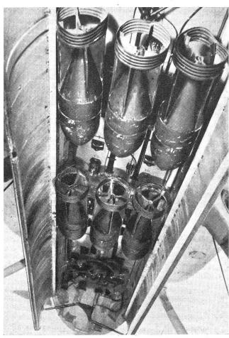
Bombenschacht eines mittleren italienischen Bombers. Die Bomben sind waagrecht aufgehängt, die im Bilde nach den Seiten hin geöffneten Fallklappen sind während des Fluges geschlossen, um den Luftwiderstand zu verringern.
