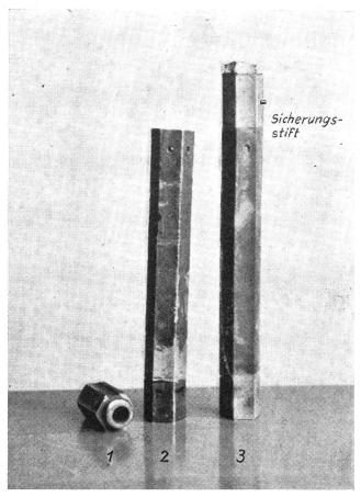
Englische 6-Kant-Stabbrandbombe neuerer Konstruktion mit kleiner Raumbeanspruchung: 1. Abgeschraubter Zündkopf. 2. Bombenkörper mit Bodenstück aus Eisen, oben die Entgasungslöcher. 3. Vollständige Bombe. Die Windhülse aus Weifsblech wurde beim Aufprall auf den Boden abgeschert.
