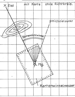
längerung nach hinten liegt. Beim Meßdreieckverfahren wird der Stellungsunterschied mittels des Meßdreiecks festgestellt. Beim Hilfszielpunktverfahren fällt die Berechnung des Stellungsunterschiedes weg.
