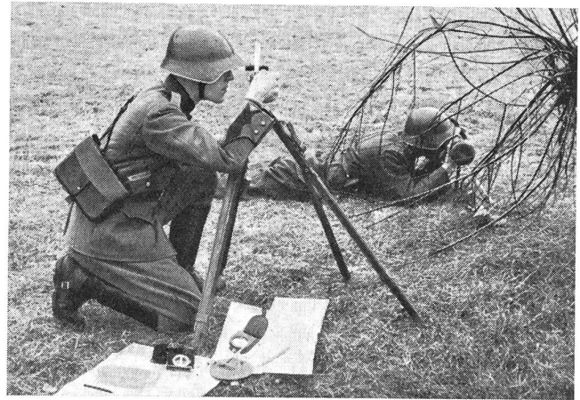
Photographie Nr. 1: Zens.-Nr. IX b B 3096. Die Richtstelle , wo der Zugführer mit Richtkreis, Flugbahnkarte, Mefydreieck, Thermometer, Barometer, Karte, Flugbahnkarte und event. Kompaß seine Berechnungen macht. Zur Bestimmung der Distanz hat er den Telemeternmann bei sich.
