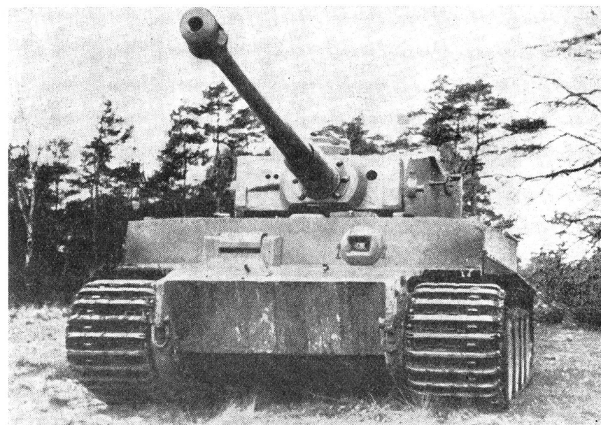
Der neue deutsche Panzerkampfwagen «Tiger». Merkmale: niedrige, breite Bauart, schwenkbarer Geschützturm mit 7,5-cm- oder 10,5-cm-Langrohrkanone mit Mündungsbremse, Laufwerk mit breiten Raupenbändern, Totalgewicht zirka 50 Tonnen.
