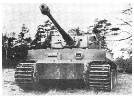
Der neue deutsche Panzerkampfwagen «Tiger». Merkmale: niedrige, breite Bauart, schwenkbarer Geschützturm mit 7,5-cm- oder 10,5-cm-Langrohrkanone mit Mündungsbremse, Laufwerk mit breiten Raupenbändern, Totalgewicht zirka 50 Tonnen.
