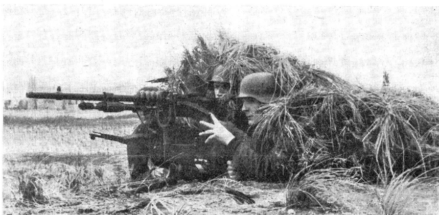
Einsatz mit fremden Waffen. Deutscher Maschinengewehrtrupp mit französischen Hotchkiss-Mg. Die Feuerkadenz dieser Waffe beträgt 450 Schuß pro Minute gegenüber 900 Schuß des deutschen Mg.-Mod. 34.
