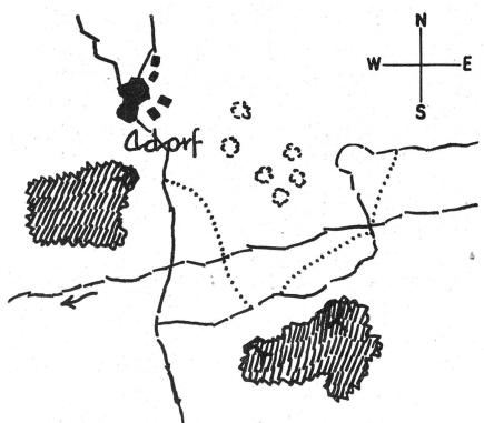
Schlechtes Beispiel: Unsaubere Linienführung (kein Unterschied zwischen Bach und Strafse). Die Wälder sind zu dunkel schraffiert, das Dorf sogar gänzlich ausgefüllt: in beiden Fällen ist die Signatureneinzeichnung erschwert. Ueberflüssige Windrose.
