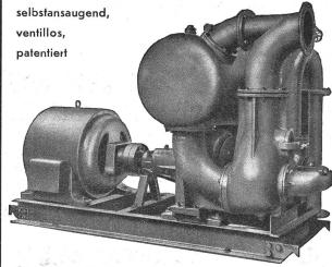
Saughöhen bis 9 m, Leistungen 1-500 Liter/Sek. Kein Bodenventil · Keine Klappe im Saugstutzen · Keine Hilfs \*Vakuum \* Pumpe · Jederzeitiges automatisches Ansaugen auch nach Lufteintritit im Saugrohr. Keine reibenden, sich abnützenden Flächen, daher unempfindlich gegen Sand, Schlamm und Kies.
