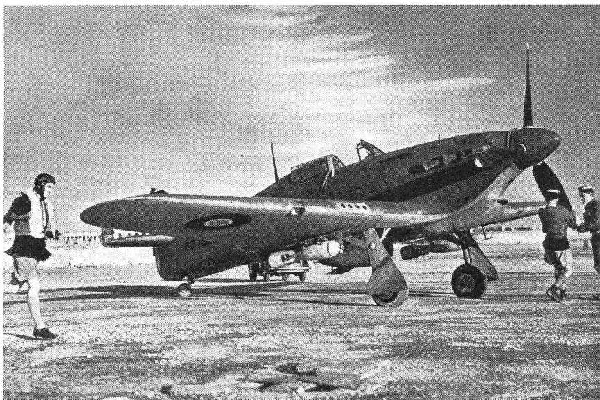
Hurricane-Jagdmaschine als Tiefflugbomber; unter jedem Flügel ist eine 100-kg-Bombe sichtbar.
