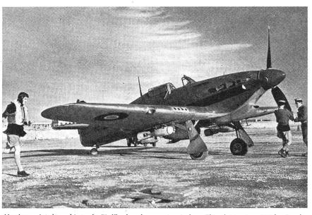
Hurricane-Jagdmaschine als Tiefflugbomber; unter jedem Flügel ist eine 100-kg-Bombe sichtbar.
