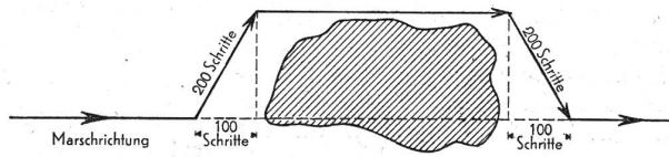
Leuchtstrichen liegenden Nadel. Die Entfernung in der Richtungssachse vom Ausgangspunkte der Umgehung bis zum Punkt, wo die ursprüngliche Richtung wieder aufgenommen wird, ist gleich der Anzahl der gezählten Schritte.
