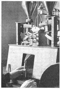
Präzisionswaage für das Abfüllen von Pulverladungen.
