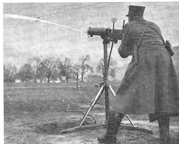
Das Wasserstrahlgerät. Vermittels einer Spezialvorrichtung ist das Mg. an eine Wasserleitung angeschlossen; durch das Abdrücken wird ein dünner Wasserstrahl gegen die vorüberschwebende Flugzeugscheibe gespritzt. (Z.-Nr. VI R 11870.)
