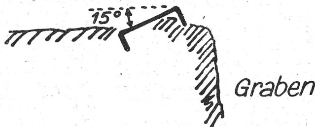
Kugelfang-Anlage mittels U-Eisen.
