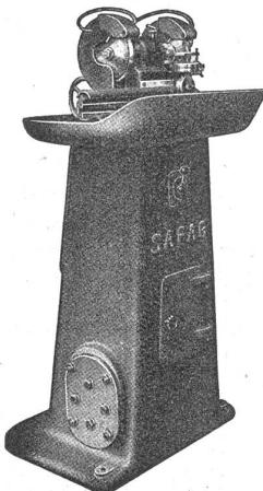
Maschine zum Schleifen von Hartmetalldrehstäben
