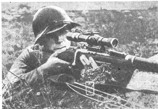
Das Mosim-Nagaut-Gewehr Mod. 91/30 mit Zielfernrohr. Gewicht 4 kg; Kaliber 7,62 mm, Länge 1,23 m; Visierbereich 2000 m; Anfangsgeschwindigkeit des Spitzgeschosses: 860 m/s.
