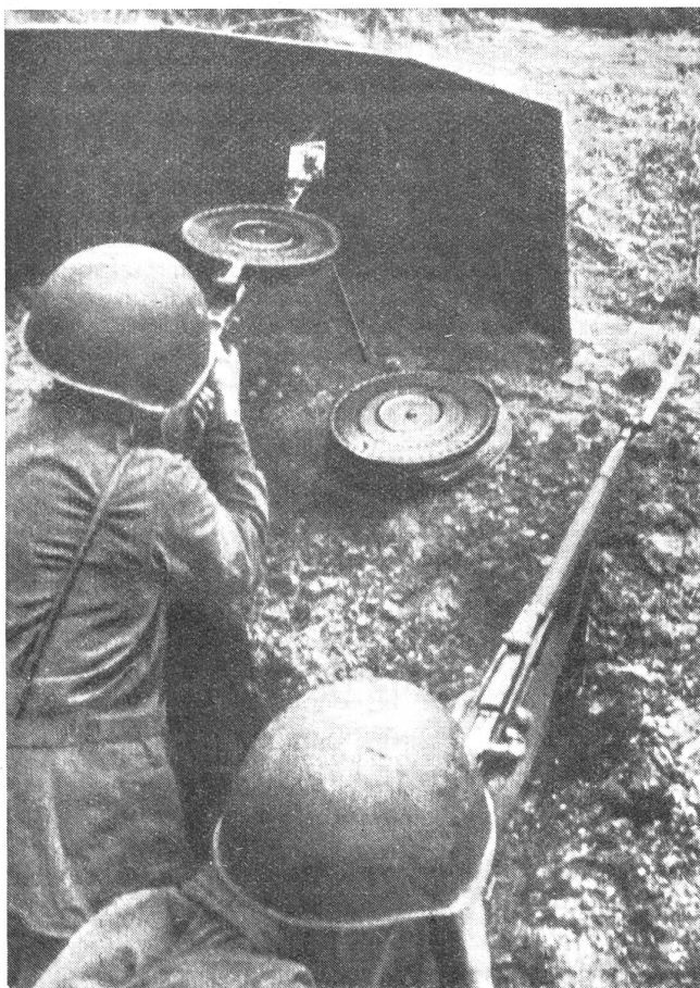
Das Degtjarew-Lmg. Mod. 1930. Gasdruckkader mit Luftkühlung; Patronenzufuhr aus Trommel zu 49 Schuß; Feuergeschwindigkeit 600 Schuß pro Minute; Gewicht 9,4 kg. Der im Bilde sichtbare Schutzschild ist improvisiert.
