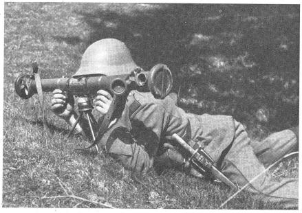
Der Telemeter ist das zuverlässigste Instrument für die Bestimmung der Schufidistanzen, es ist aber mit einem mittleren Mehfehler von 5 % zu rechnen. Gegen Erdziele ist, sofern es die Zeit erlaubt, die Messung dreimal auszuführen und aus der Summe der Messungen das Mittel zu nehmen. (Z.-Nr. VI Sn 11580.)
