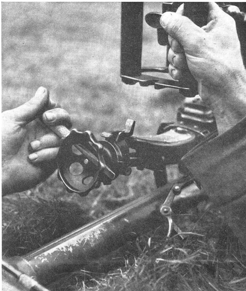
Die Verwendung des Schraubenziehers aus der Gewehrtasche als Drehhebel im Höhenrichtrad ermöglicht auch bei 8 und mehr Promille Tiefenfeuer ein rasches Streuen. (Z.-Nr. A/Er/444.)
