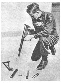
Die Hauptbestandteile der «Sten»-MP. (von links nach rechts): Anschlaggestell, Magazin, Schlagstift, Schlagfeder und Verschluß. Der Pistolenlauf ist mit einem Feuerscheindämpfer versehen.
