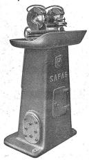
Maschine zum Schleifen von Hartmetalldrehstählen
