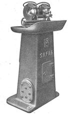
Maschine zum Schleifen von Hartmetalldrehstählen
