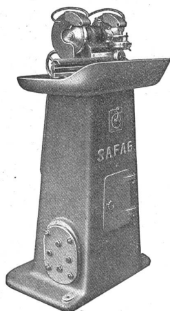
Maschine zum Schleifen von Hartmetalldrehstählen
