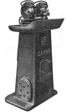
Maschine zum Schleifen von Hartmetalldrehstählen
