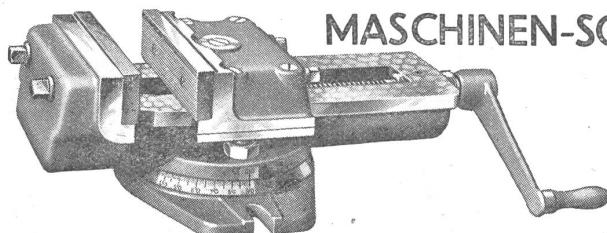
**MASCHINEN-SCHRAUBSTOCK** Drehbar mit Gradeinteilung.
