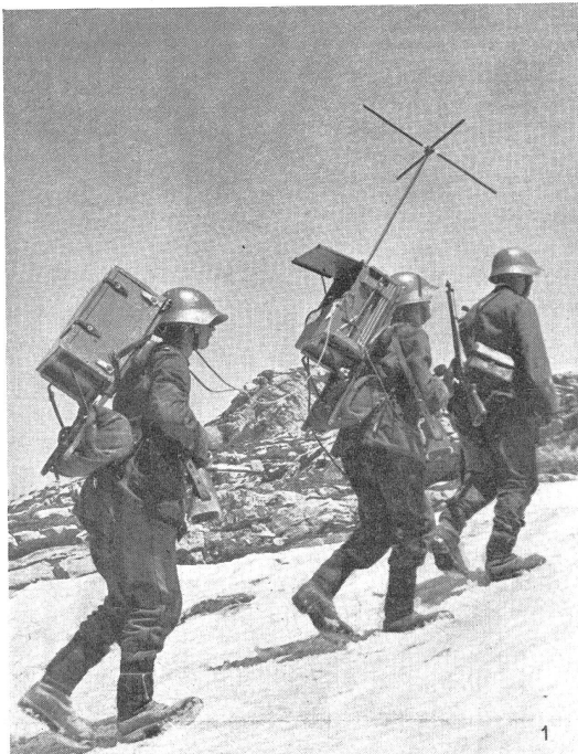
1 Die tragbare Funkstation an der Spitze der Kolonne sichert dem Kommandanten über die an den wichtigsten Punkten des Gebirgssaumpfadcs aufgestellten Zwischenstationen jederzeit die Verbindung mit seiner Truppe. — La station de radio portable à la tête de la colonne permet au commandant, grâce aux stations intermédiaires placées aux points importants du convoi muletier, d'être en tout temps en liaison avec sa troupe. — La stazione radio portabile alla testa della colonna
