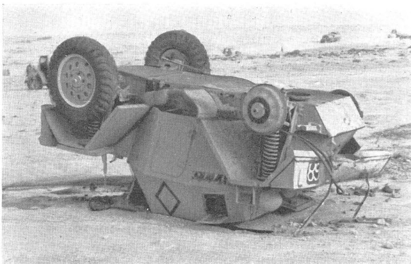
Wirkung einer Tankmine auf einen leichten Panzer-Aufklärungswagen. — Effet d'une mine anticar sur un char léger d'exploration. — Effetto di una mina anticarro su un carro armato leggero da ricognizione.
