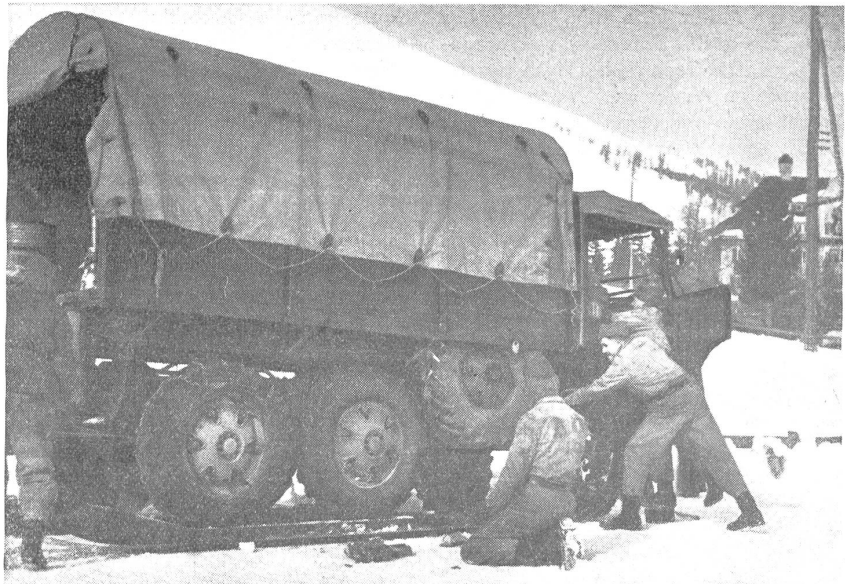
Auf schneebelegten oder vereisten Straßen wird das Abschleppen von Motorfahrzeugen durch Unterlegen von Schlittenkufen erleichtert. — Sur des routes enneigées ou défoncées, le remorquage des véhicules est facilité par l'adjonction de patins de luges. — Su strade coperte di neve o gelate, la partenza dei veicoli è facilitata aggiungendo alle ruote dei pattini speciali. (Zens.-Nr. VI B 9589.)
