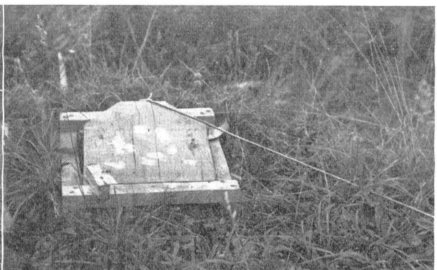
Selbstkontrollierte Fallscheibe. Ein Gummiband (alter Pneustreifen, siehe Pfeil) läßt die Scheibe beim Nachlassen des Schnurzuges wieder zurückklappen. — Cible à contrôle automatique. Lors de la détente du cordon, une bande de caoutchouc (vieux pneu, voir la flèche) relève la cible. — Bersaglio mobile controllato automaticamente. Un nastro di gomma (vecchio copertone-vedi freccia) fa ritornare il bersaglio nella posizione di partenza tirando una corda. (Zens.-Nr. N M 7390/91.)
