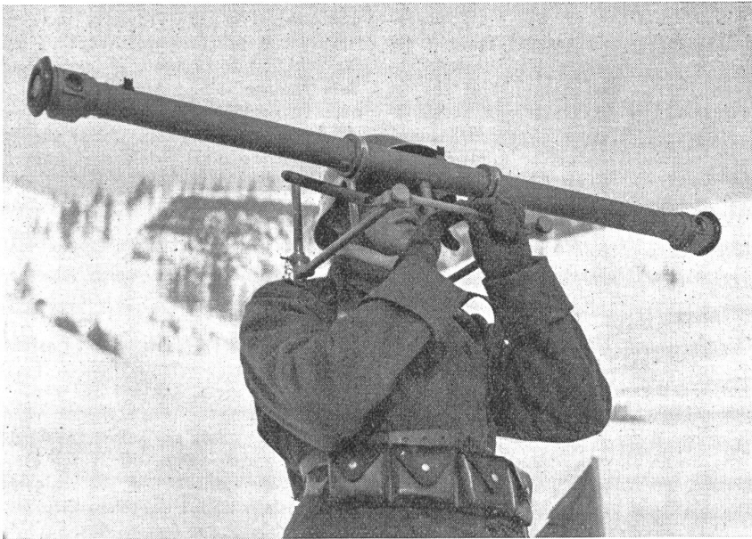
Laufend meldet der Flab-Telemetermann die gemessenen Schußdistanzen zum Ziel. — Le télémètreur DCA indique les chiffres de distance nécessaires pour le tir. — Il telemetrista della batteria controaerea annuncia volta per volta le distanze di tiro. (Zensur-Nr. VI B 1017.)
