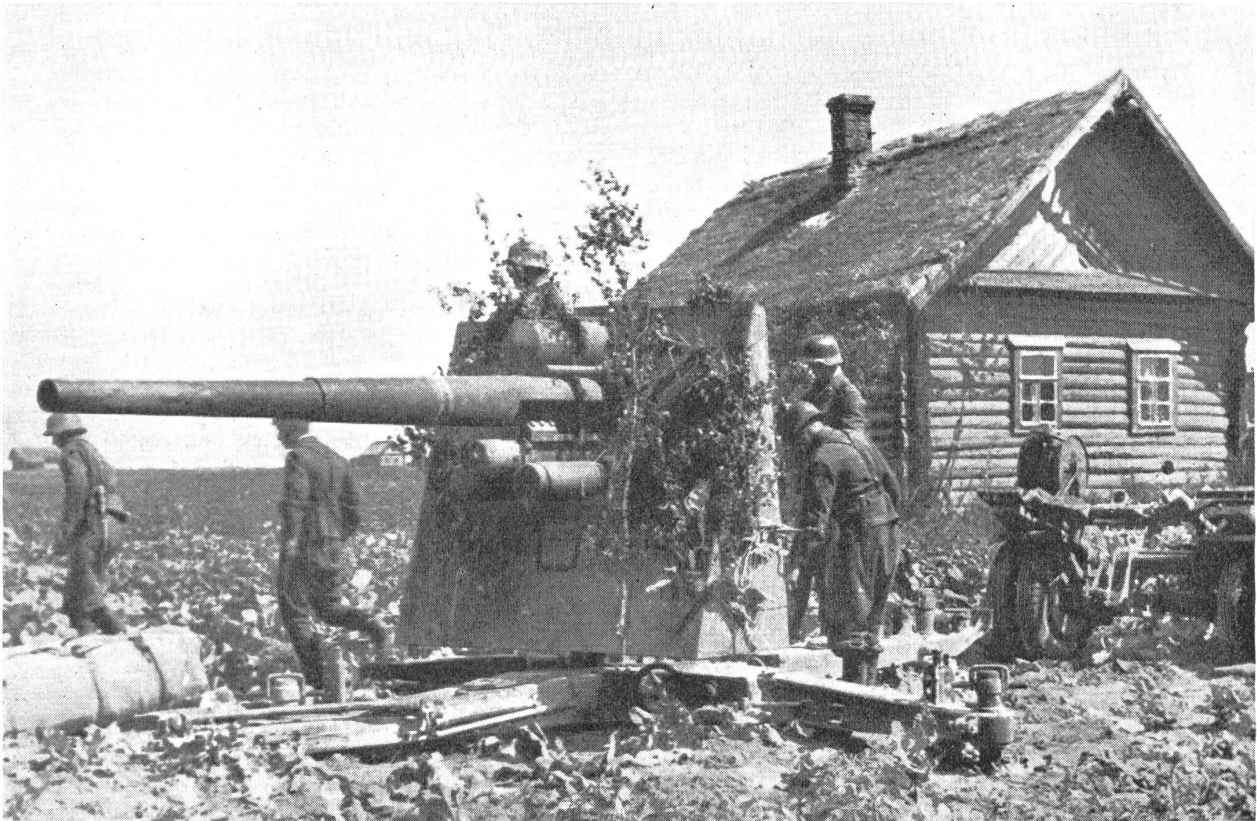
Deutsches 8,8 cm schweres Flabgeschütz an der russischen Front. Der Schutzschild verhindert eine stärkere Gefährdung der Geschützbedienung bei Verwendung des Geschützes zur Panzerabwehr.
