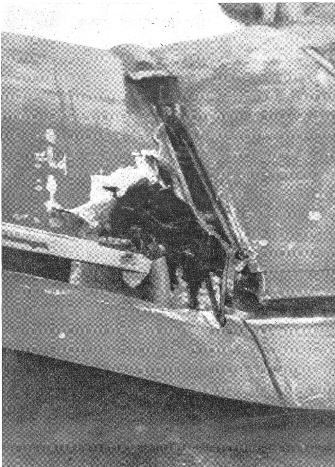
Flackvolltreffer in die linke Tragfläche eines Sturzkampfflugzeuges Junkers 87. Trotz dieser gefährlichen Verletzung des Flügels konnte die Maschine den Ausgangspunkt erreichen.
