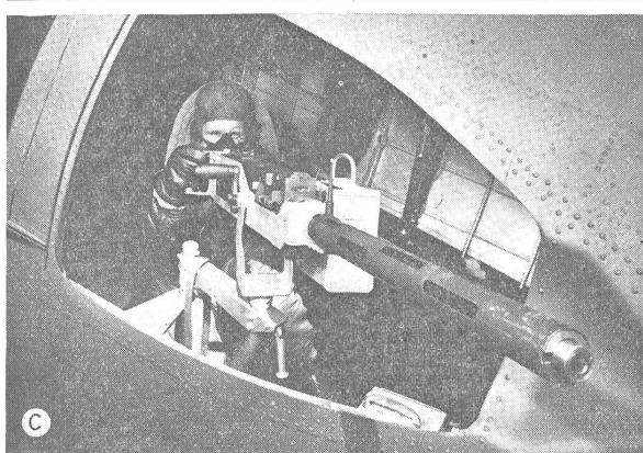
C Die Bewaffnung der fliegenden Festungen besteht aus 7 20-mm-Flugzeugkanonen, die entweder fest in den Flugzeugflügeln oder beweglich in eigentlichen Geschützständen eingebaut sind.
