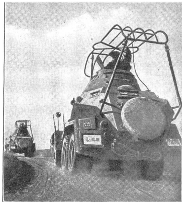
Bild 2. Dreiaxige Panzer-Spähwagen mit ihrem typischen Antennengestell für den Funkverkehr.
