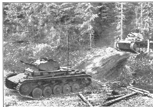
Bild 4. Patrouille mittlerer Panzer-Kampfwagen (5 Laufräder) beim Vorbrechen aus einem Walde. (Bewaffnung 1—2 Mg, 1 Panzerkanone 20 mm).
