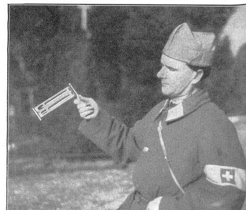
... indes hier mit dem Schwenkthermometer die Lufttemperatur festgestellt wird.
