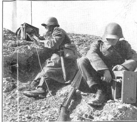
Ist der Apparat in Stellung, so wird der nötige Strom in einem kleinen Handgenerator erzeugt. Dadurch werden die Batterien geschont und das Gerät nachschubfrei. (A Er 552.)
