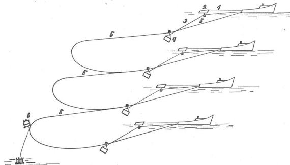
Die Mehrschiffssgeräte sind auf folgendem Prinzip aufgebaut (Zeichnung 3): je nach der gewünschten Tauchtiefe wird die Schleppboje (2) an einer kürzern oder längeren Bojenleine (1) geschleppt, wobei eine kurze Leine eine größere Tauchtiefe des Drachens 4 ergibt und umgekehrt. Die Drachenleine (3) führt vom Schiffsheck durch die Tragrolle der Schleppboje (2) zum Drachen. Die Suchleine (5) geht durch die Drachenrollen von Deck zu Deck und ist dort in Auslinkvorrichtungen
